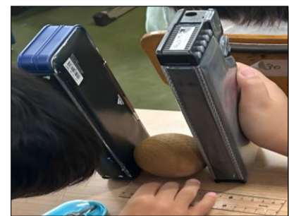
図 10 工夫して球の直径を測る様子
