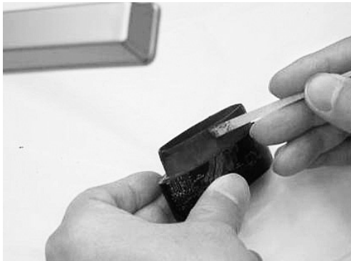
写真17 塗膜の段差際に下地付け
