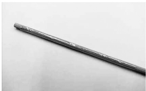
写真11 竹の芯棒に離型の為のラップを巻く
