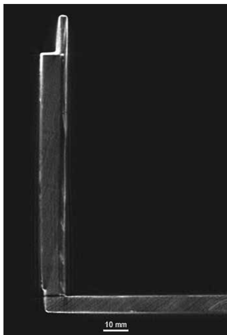
図10 身の左側板の鉛直断面画像 (図9bの左側の拡大図)。側板は2枚重ねとなっている
