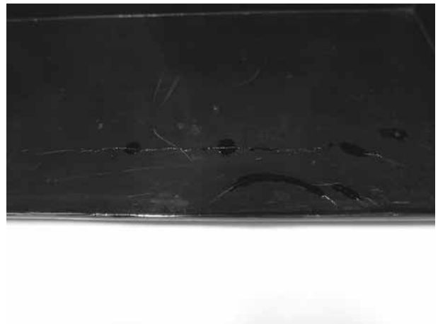
写真 38・39 身の内側、剥離塗膜の麦漆接着
