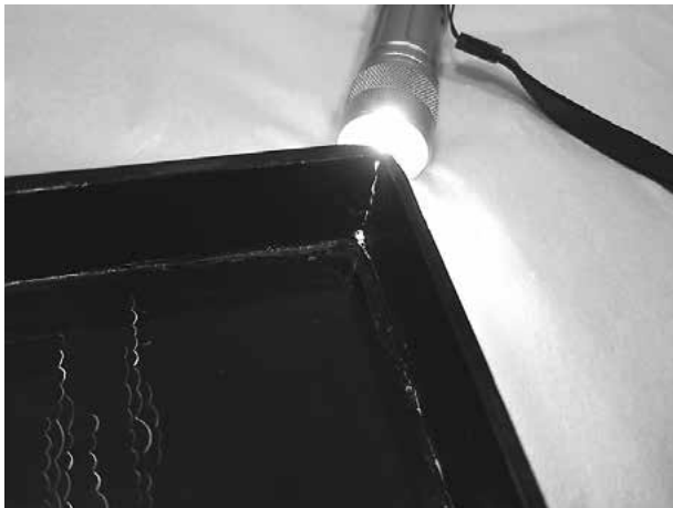
写真8・9 蓋鬘の亀裂と隙間
