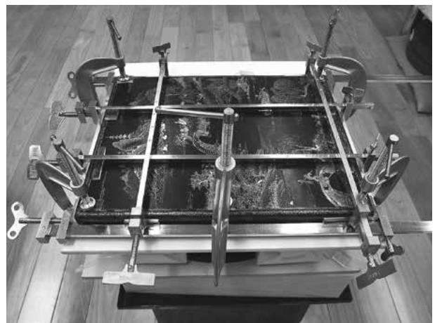
写真 37 ハタガネ、クランプで圧着固定
