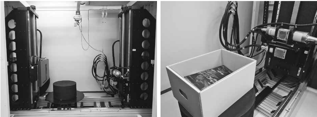
写真54 X線CTスキャナ（左）および調査風景（右）
