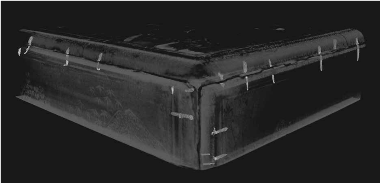
図5 蓋の正面左角のボリュームレンダリング（3D）画像（高倍率撮影）。釘と思われる領域を抽出し強調したもの。側板同士の接合部には両側板の方向に釘が打ち込まれている
