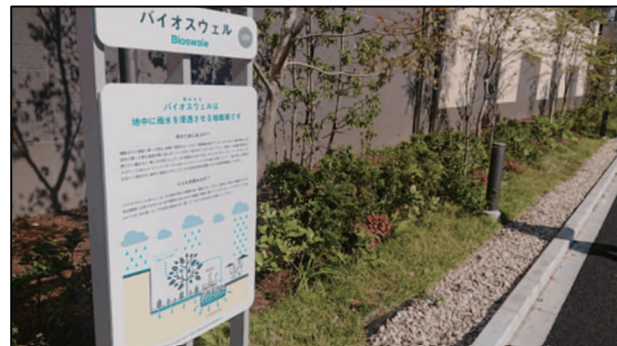
民有地内に整備されたバイオスウェル 出典：南町田グランベリーパーク HP
