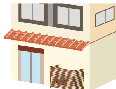
ルーバーによる遮蔽の事例
