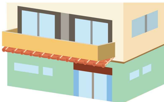
バルコニー下に瓦面が隠れている
