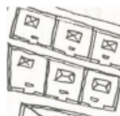
形態は奇棟屋根が多い
