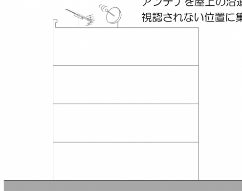
屋上に共同化を図り景観に配慮した例
